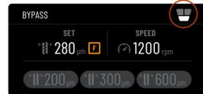
Wenn die Klappe der Mahlkammern offen ist, ermöglicht das Touch Display die Einstellung des Abstands zwischen den Mahlwerken und der für die Umgehung gewünschten Geschwindigkeit anhand personalisierbarer Voreinstellungen.
